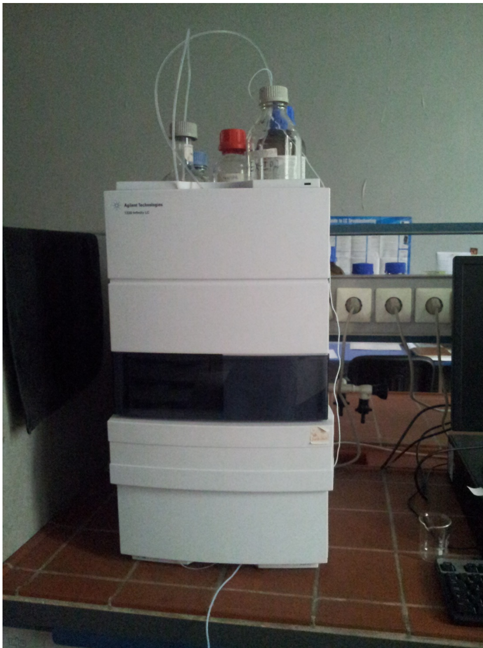
სურათი 2: Agilent 1220 სერიის სითხური ქრომატოგრაფი
