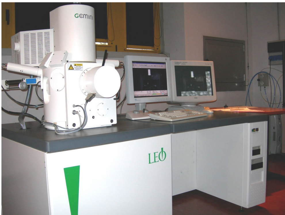
სურათი 6. Zeiss წარმოების ელექტრონული მიკროსკოპი Gemini გარჩევადობა 1.0 ნმ-დან, Gemini სვეტით და ESD დეტექტორით.
