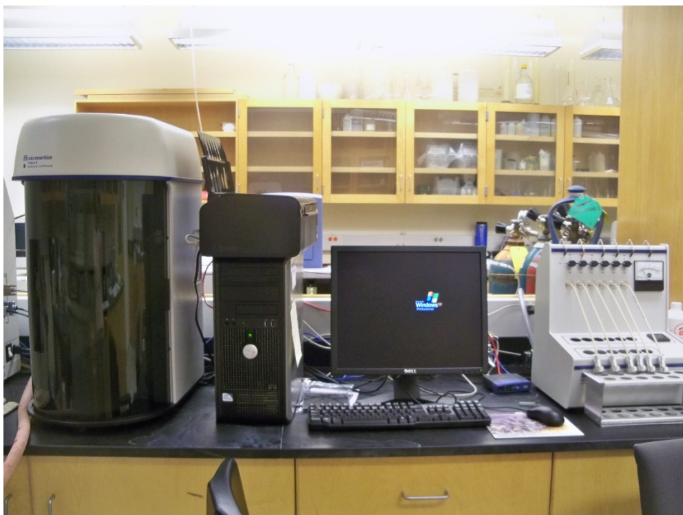
სურათი 5. Micromeritics -ის წარმოების Tristar II Surface Area and Porosity System 3020
